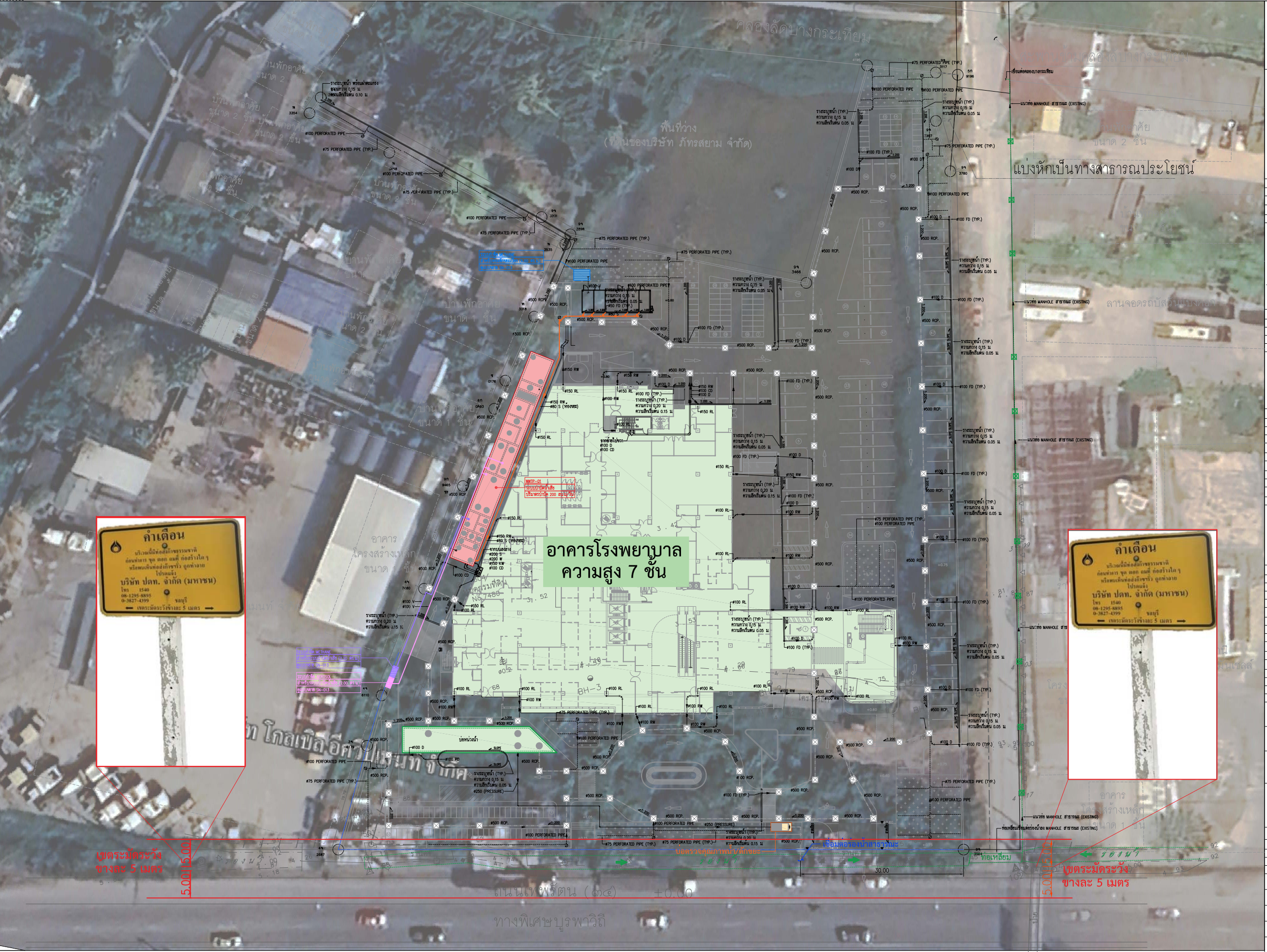
รูปที่ 4.3.8-1 ผังแสดงป้ายเตือนแนวท่อสาธารณูปโภคของบริษัท ปตท.จำกัด (มหาชน) บริเวณริมถนนเทพรัตนด้านหน้าโครงการ และแสดงตำแหน่งระบบสาธารณูปโภคใต้ดินภายในโครงการ
