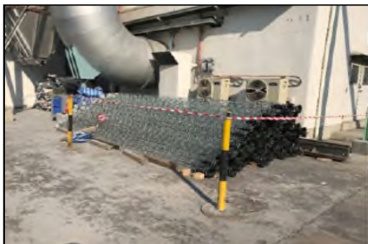
รูปที่ 2 ตัวอย่างอะไหล่สำรองระบบควบคุมมลพิษทางอากาศ
