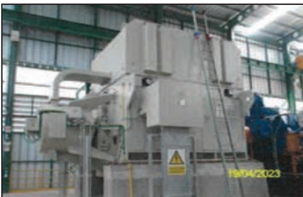
รูปที่ 51 การปิดครอบอุปกรณ์เครื่องจักร ที่มีเสียงดัง
