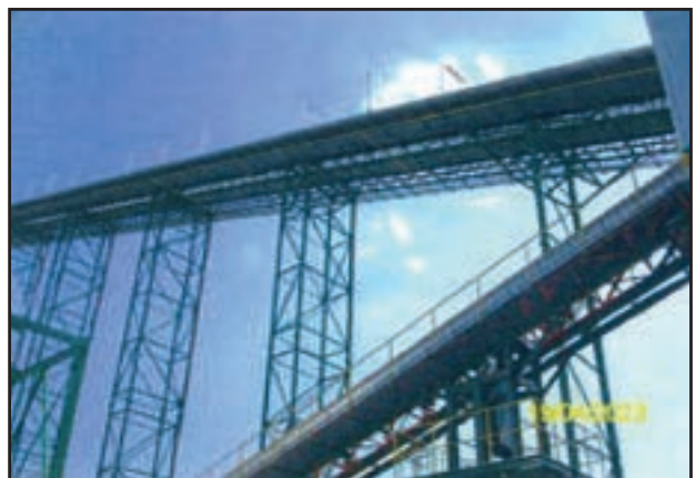
รูปที่ 41 ระบบสายพานลำเลียงเชื้อเพลิงจากอาคารป้อนเชื้อเพลิงไปยังหม้อไอน้ำ (ระบบปิดครอบ)
