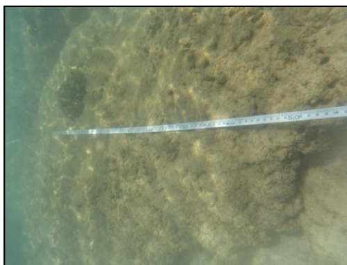
รูปที่ 3-17 การวางแนวสำรวจในแนวปะการัง ด้วยวิธี Line Intercept Transect
