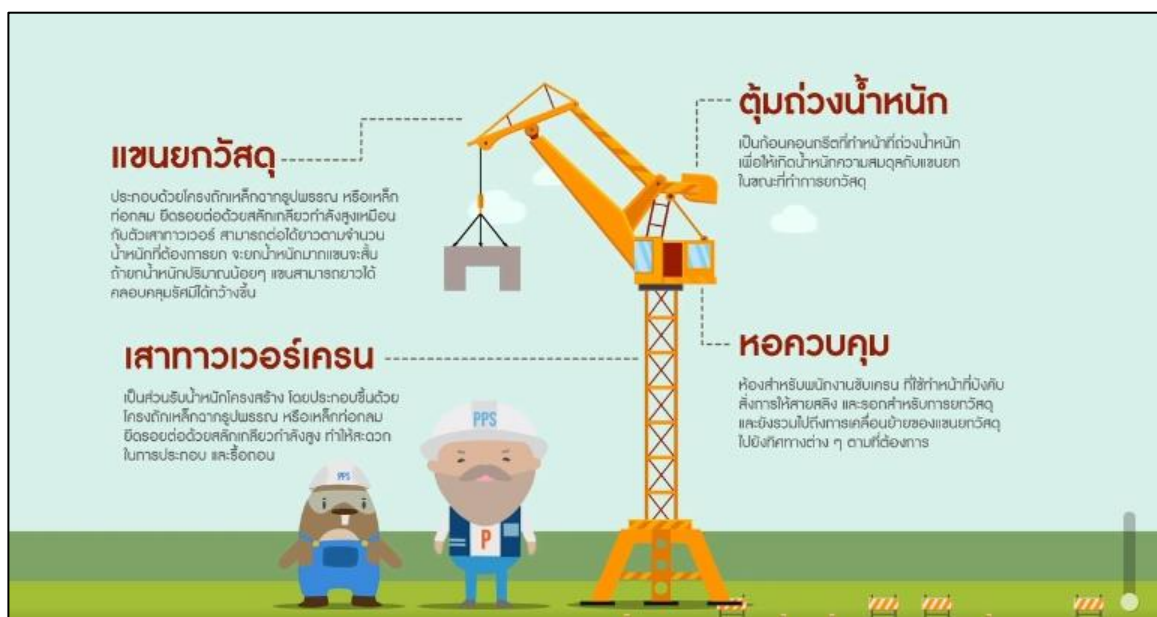
รูปที่ 4.4.2-2 ส่วนประกอบของทาวเวอร์ เครน (Tower crane) แบบบูมกระดก
