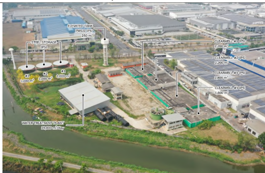
ระบบผลิตน้ำประปา และถังเก็บน้ำประปาและหอถังสูงเก็บน้ำใส (P5)
