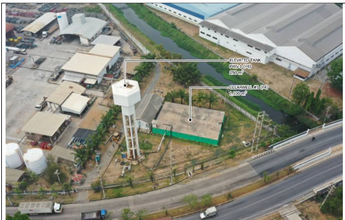
ถังเก็บน้ำประปาและหอถังสูงเก็บน้ำใส บริเวณระบบส่งจ่ายน้ำประปา (P4)
