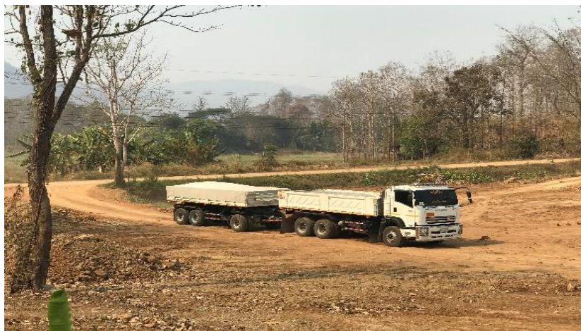
รูปที่ 2.7-4 ปิดคลุมท้ายกระบะรถบรรทุกขนส่งวัสดุอุปกรณ์ก่อสร้าง
