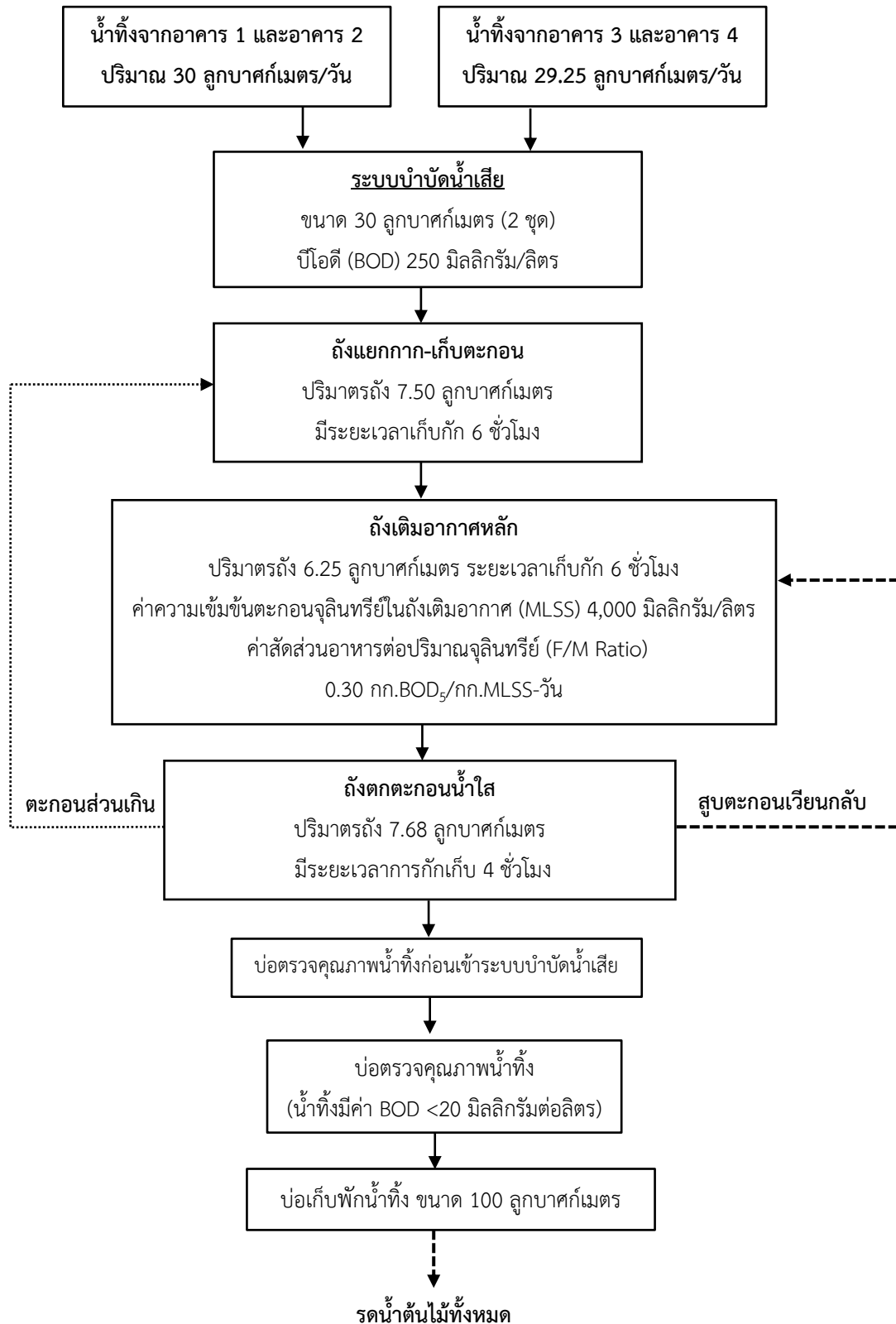
รูปที่ 2.9.2-17 ขั้นตอนการทำงานของระบบบำบัดน้ำเสียชนิดเติมอากาศเลี้ยงตะกอนเวียนกลับ (Aeration activated sludge process.,AS) ขนาด 30 ลูกบาศก์เมตร
