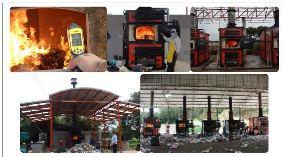
รูปที่ 2.9.5-17 ตัวอย่างวิธีการทำงานของเตาเผามูลฝอยระบบควบคุมอากาศ (Air Control Incinerator : A.C.I)
