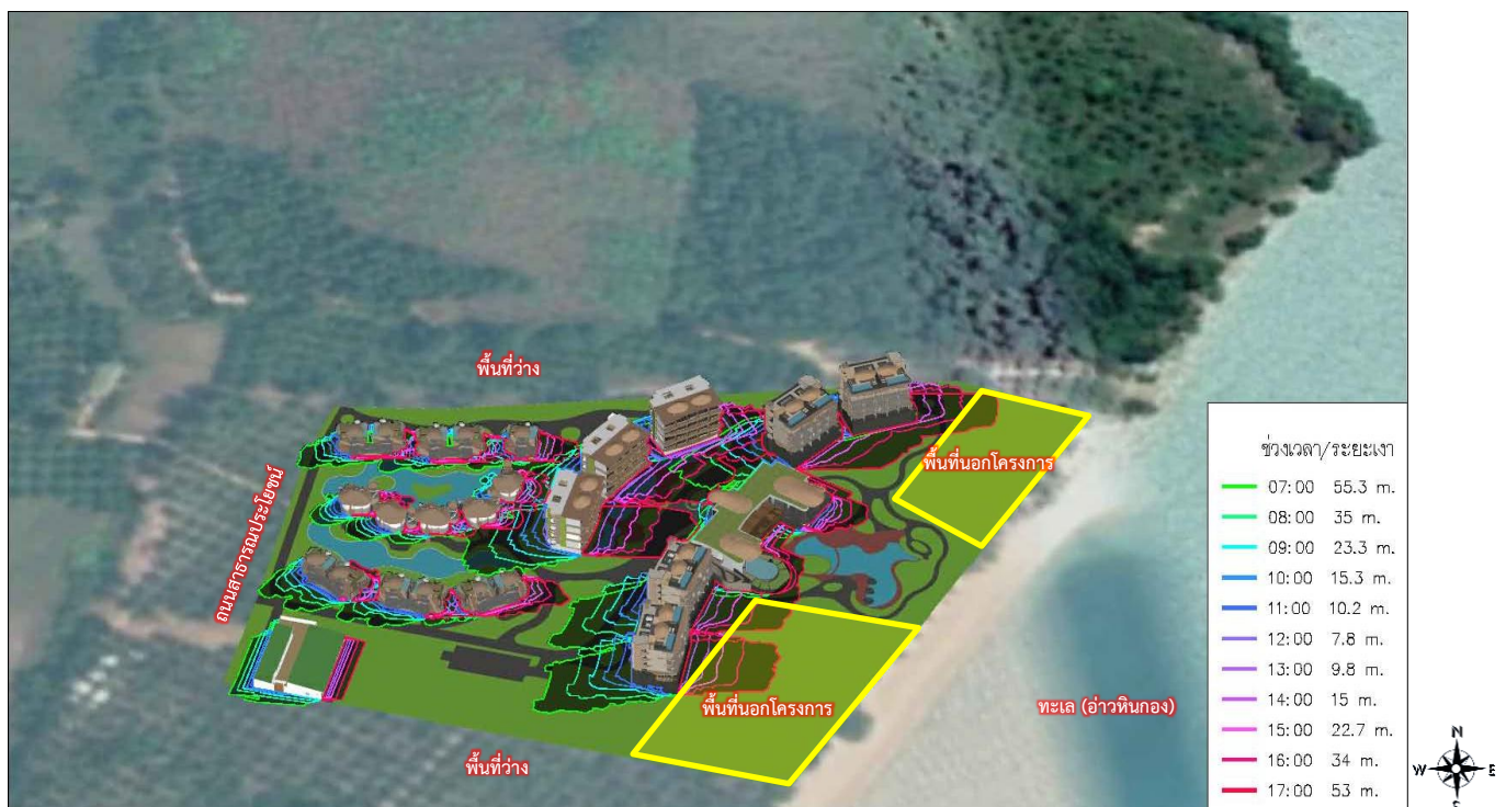
รูปที่ 4.3.8-2 แบบจำลองการบังแสงต่อพื้นที่ทุกชั่วโมงที่ทำการจำลอง วันที่ 21 เดือนมิถุนายน พื้นที่ส่วนที่ 1
