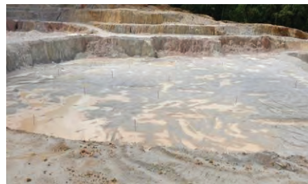
ลักษณะการวางตำแหน่งเก็บตัวอย่างแร่ ในบริเวณพื้นที่หน้าเหมืองก่อนทำการขุด ถ่ายจากพิกัด 1100191N 465115E L7018
