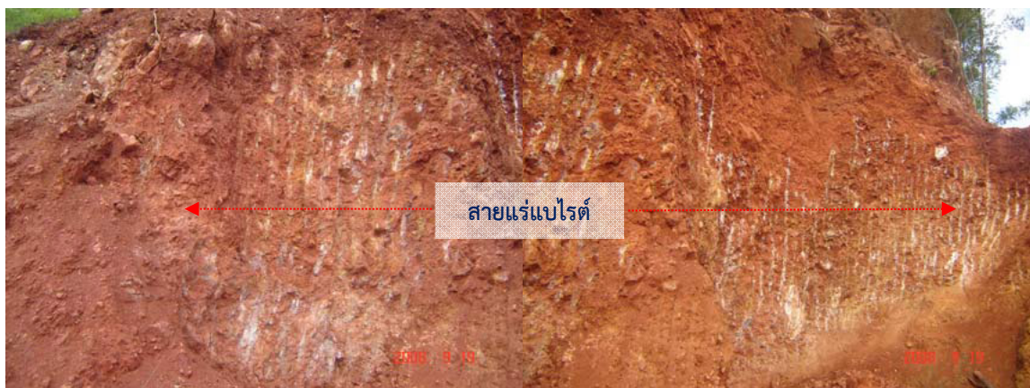
รูปที่ 2.4-3 การวางตัวของสายแร่แบบไรต์ในเขตคำขอประทานบัตรที่ 3/2548 ความกว้างของสายแร่ประมาณ 20 ม. ความลึกมากกว่า 30 ม.
