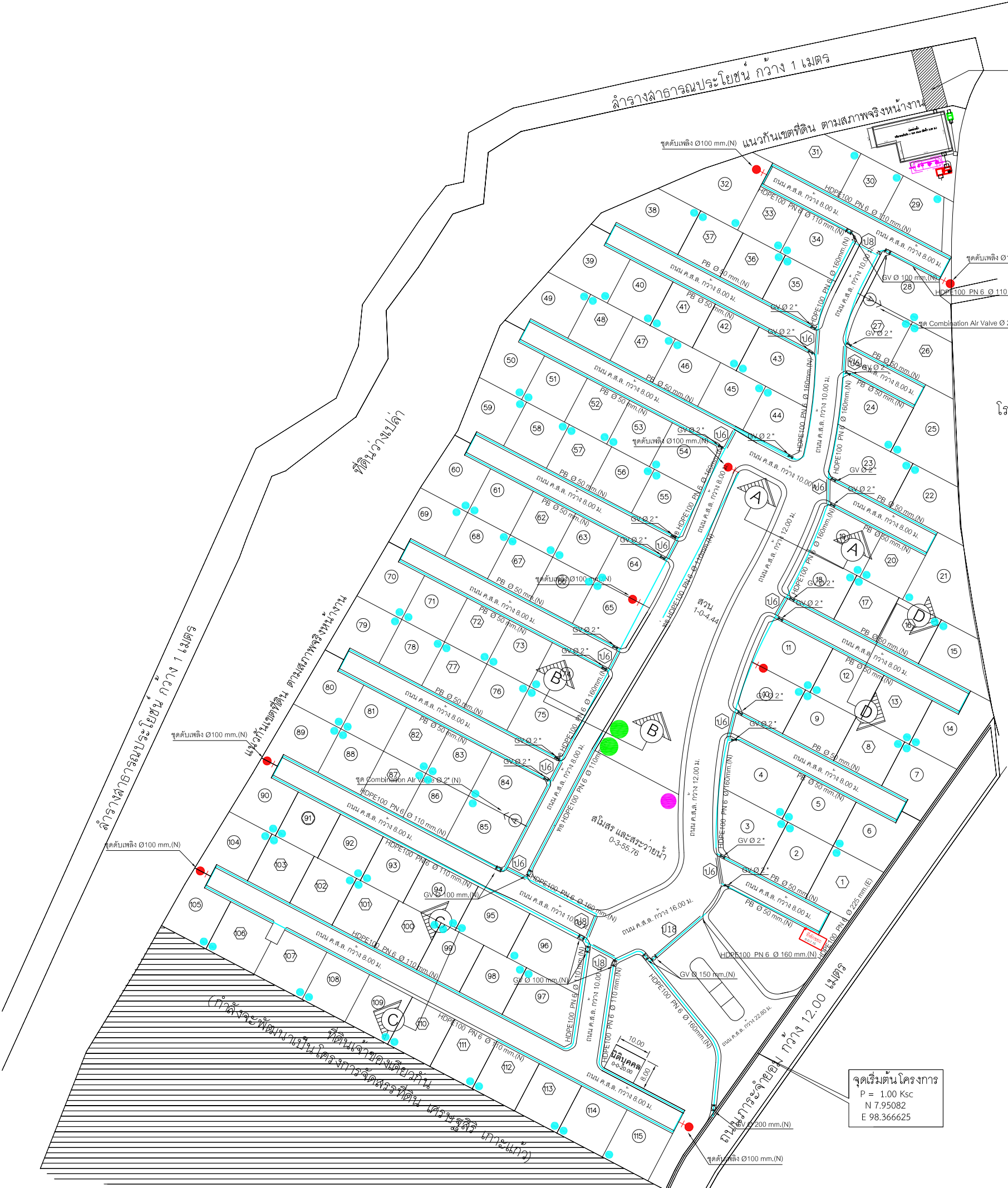
รูปที่ 2-13 ผังระบบประปา และตำแหน่งหัวจ่ายน้ำดับเพลิง
