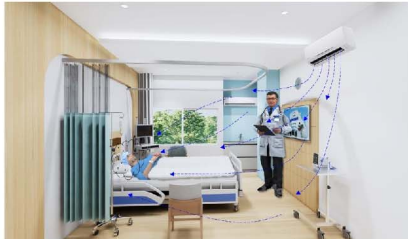
รูปที่ 2.6.6-2 แสดงทิศทางการไหลของกระแสลมสำหรับห้องแยกเดี่ยวผู้ป่วย (Isolate Room)
