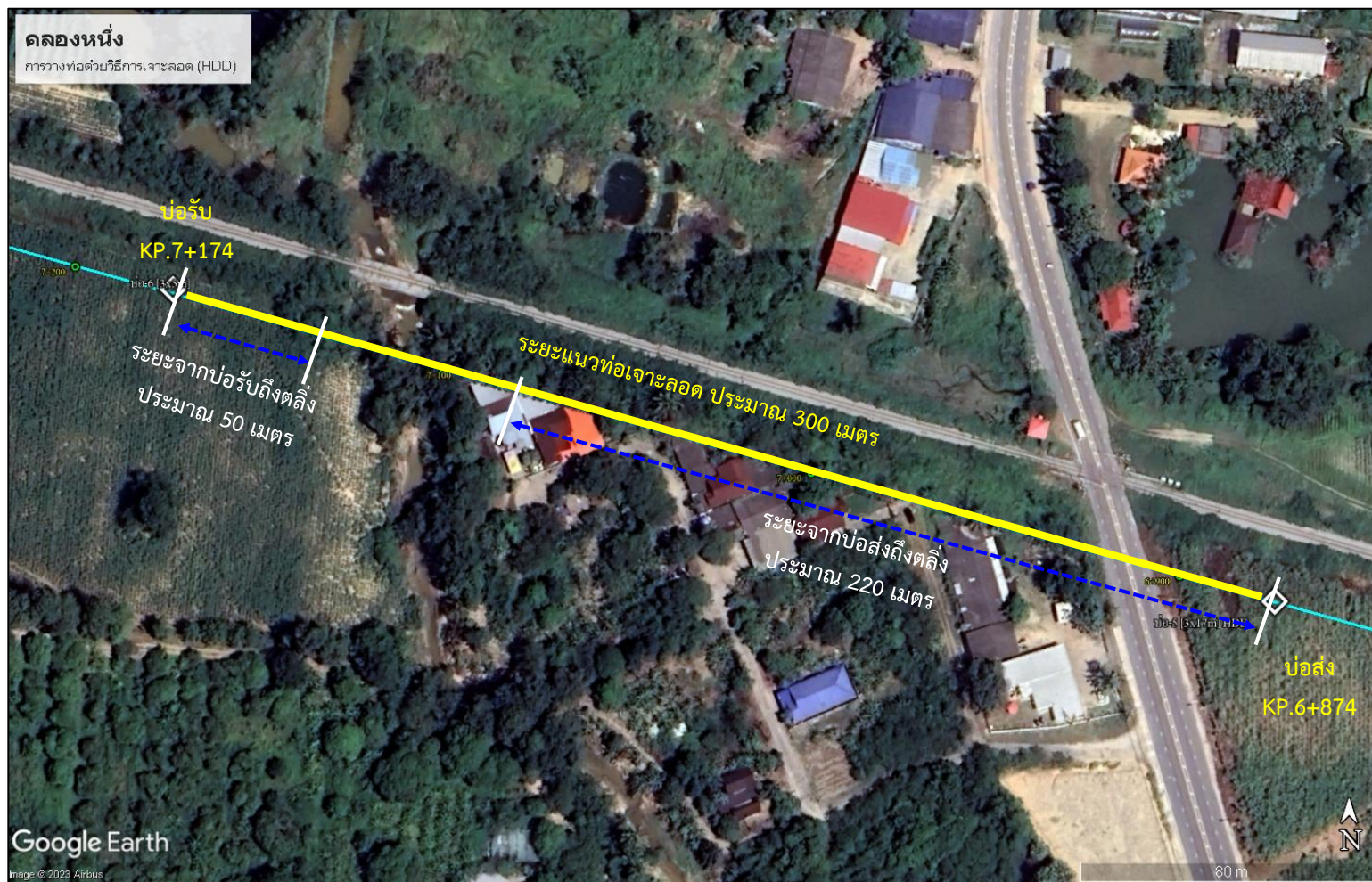
รูปที่ 2.6-11 ตัวอย่างตำแหน่งบ่อรับ-บ่อส่ง และระยะแนวท่อเจาะลอด (คลองหนึ่ง)
