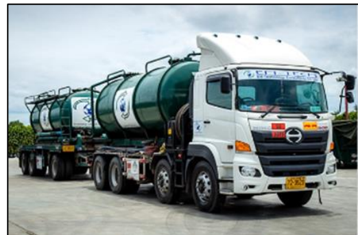
รถ ROLL OFF (TANK) พ่วง พร้อม Pump บรรทุกของเสียไม่เกิน 24 ตัน
