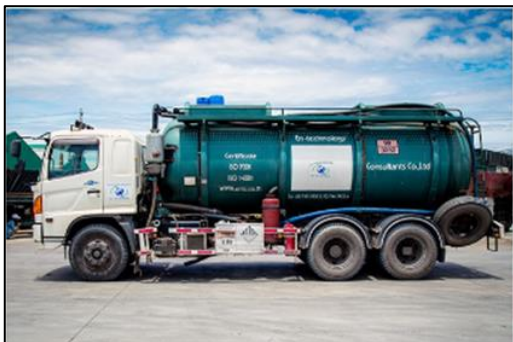
รถ FIXED TANK TRUCK พร้อม Vacuum Pump บรรทุกของเสียไม่เกิน 12 ตัน
