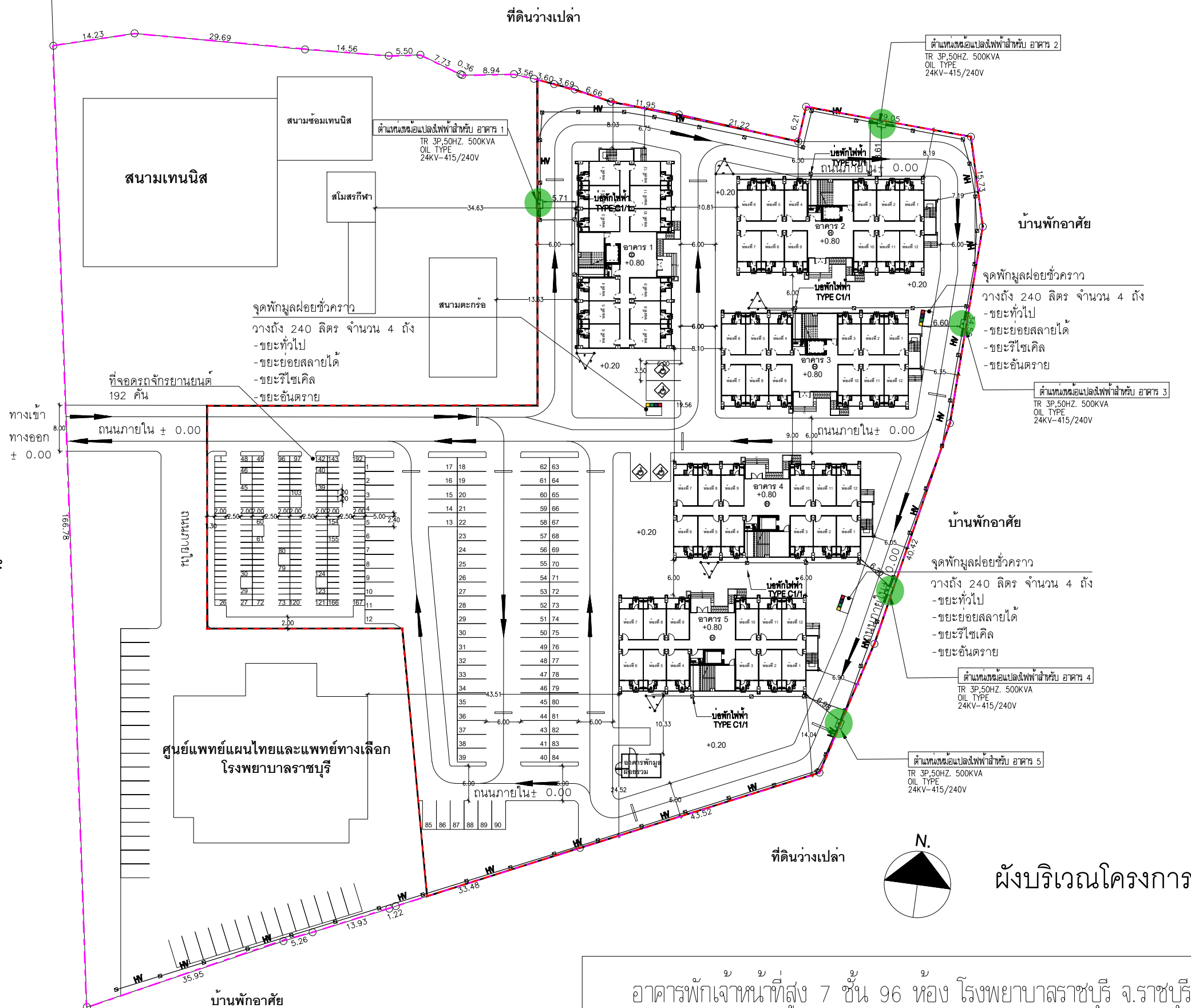
รูปที่ 2.8.5-1 ผังแสดงตำแหน่งติดตั้งหม้อแปลงไฟฟ้าของโครงการ
