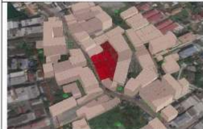
เวลา 7.00 น. ก่อนมีโครงการเกิดเงาตบึงอาคาร เกิดขึ้น 55% ของพื้นที่ทั้งหมด
