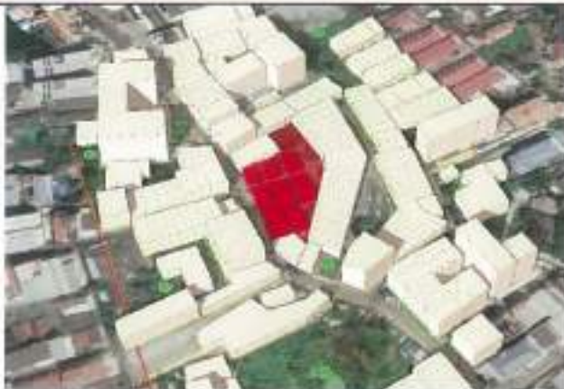
เวลา 15.00 น. ก่อนมีโครงการเกิดเงาตบึงอาคาร เกิดขึ้น 20% ของพื้นที่ทั้งหมด
