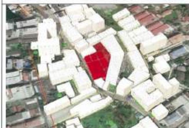
เวลา 14.00 น. ก่อนมีโครงการเกิดเงาบดบังอาคาร เกิดขึ้น 15% ของพื้นที่ทั้งหมด
