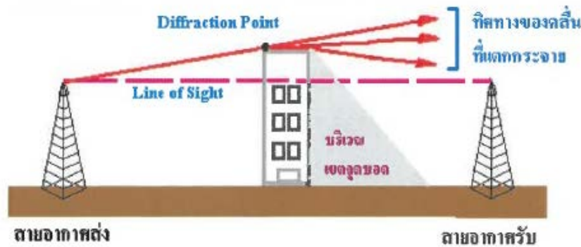
รูปที่ 4-24 การบดบังสัญญาณคลื่นวิทยุจากอาคารสูง
