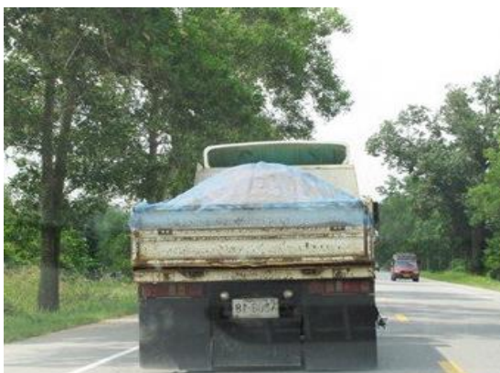
รูปที่ 5.2.4-3 การปิดคลุมท้ายรถบรรทุก และการทำความสะอาดเศษดินที่ตกหล่น
