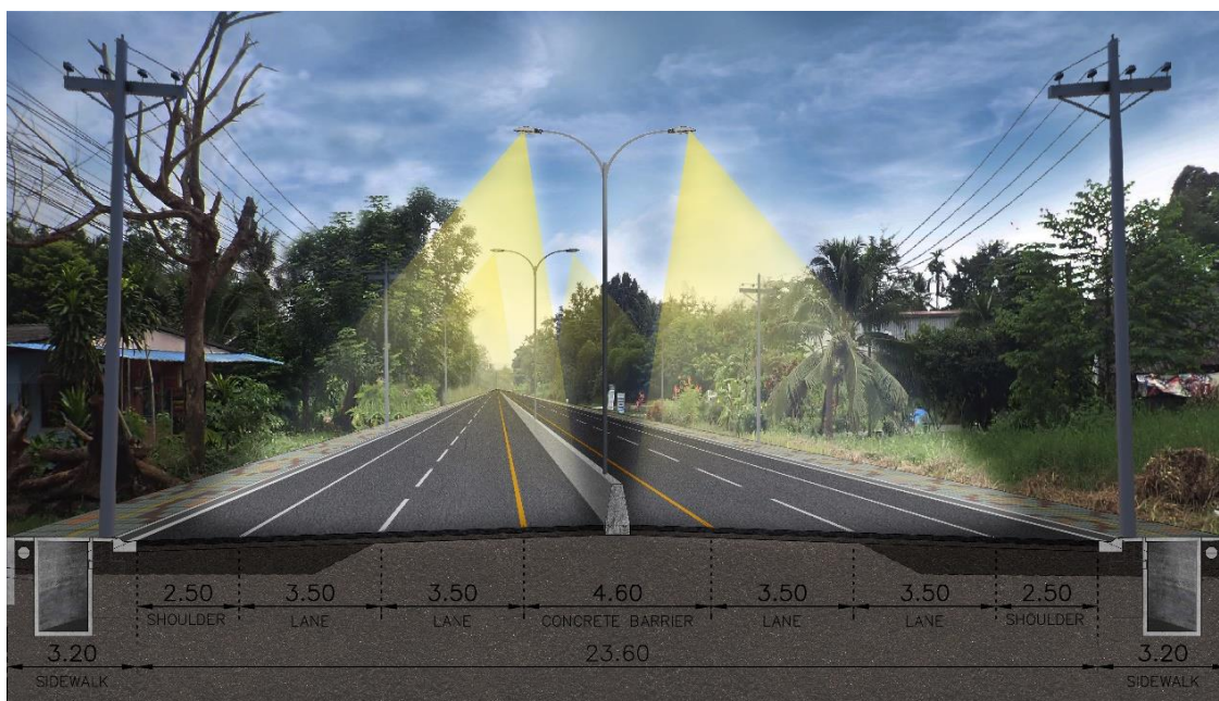
รูปที่ 2.2.7-1 รูปตัดแสดงระบบไฟฟ้าแสงสว่าง
