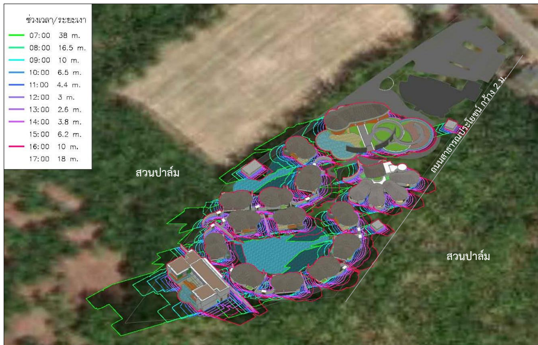
รูปที่ 4.3.8-2 แบบจำลองการบังแสงต่อพื้นที่ทุกชั่วโมงที่ทำการจำลอง วันที่ 21 เดือนมิถุนายน
