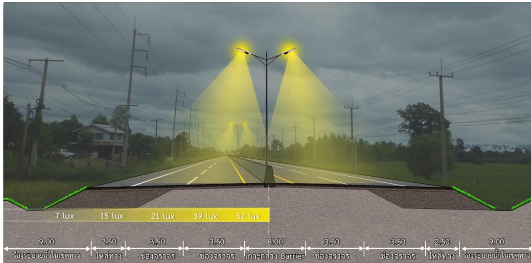
รูปที่ 7.7-2 รูปแบบระบบไฟฟ้าส่องสว่างบริเวณแนวเส้นทางโครงการ
