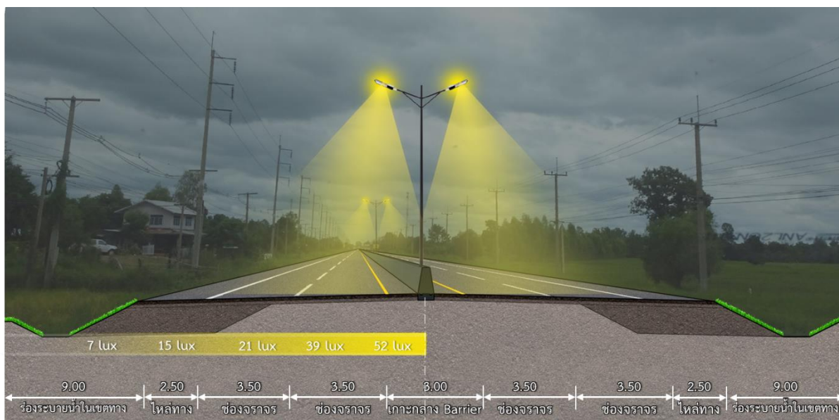
รูปที่ 4.4.5-2 รูปแบบระบบไฟฟ้าส่องสว่างบริเวณแนวเส้นทางโครงการ
