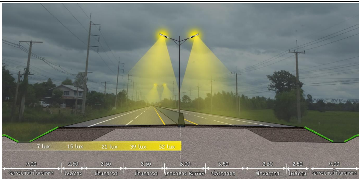
รูปที่ 2.4.8-3 รูปแบบระบบไฟฟ้าส่องสว่างบริเวณแนวเส้นทางโครงการ
