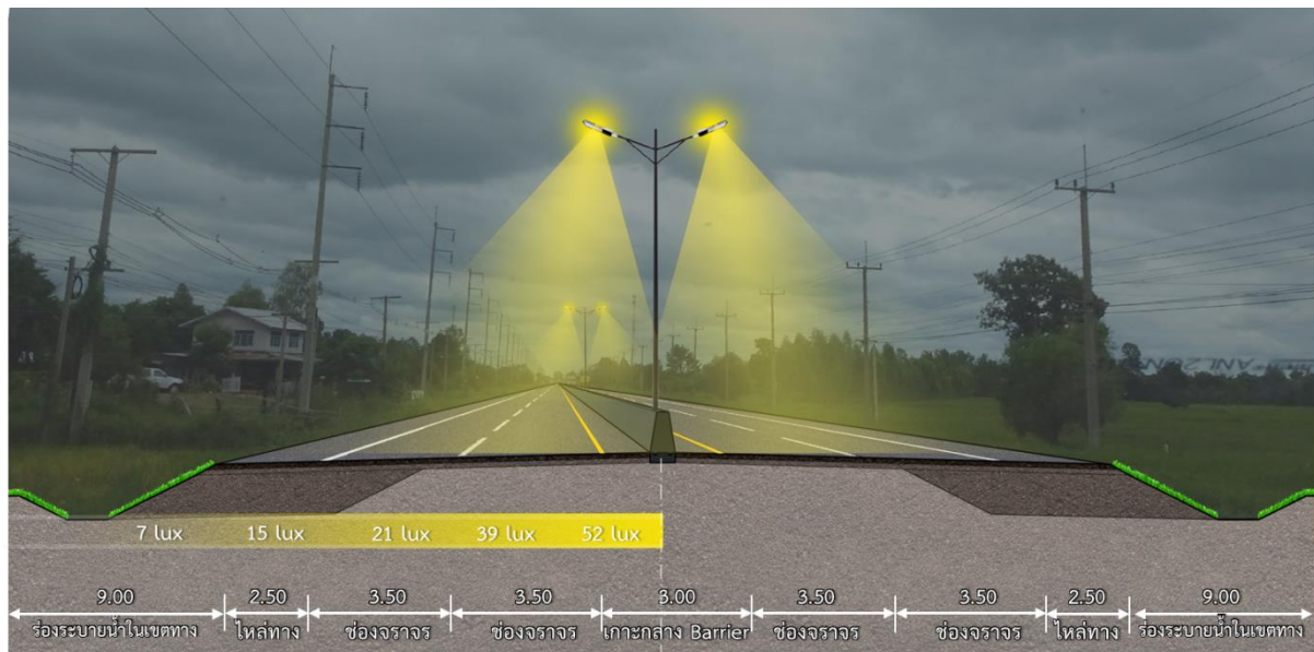
รูปที่ 3.4.5-1 รูปแบบระบบไฟฟ้าส่องสว่างบริเวณแนวเส้นทางโครงการ
