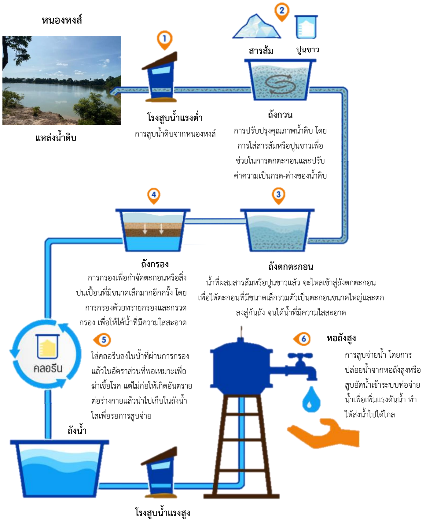
รูปที่ 3.4.1-2 ขั้นตอนการผลิตน้ำประปาเพื่อการอุปโภคในหมู่ 5 บ้านพันชี
