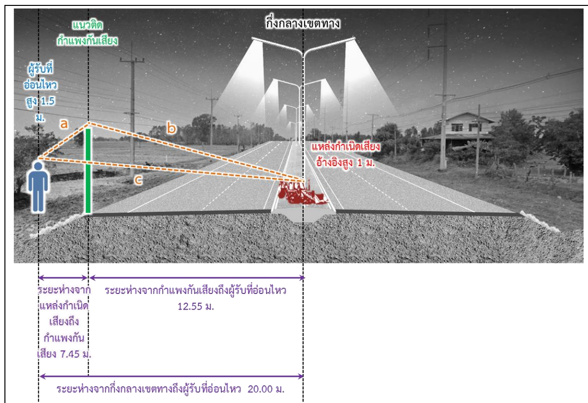
รูปที่ 4.2.5-1 ระยะอ้างอิงที่ใช้คำนวณค่า Fresnel Number ตัวอย่างการคำนวณการติดตั้งกำแพงกันเสียง ณ บริเวณหมู่ 7 บ้านไทร
