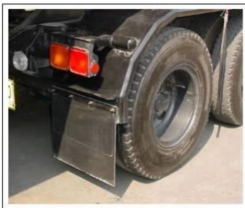
รูปที่ 5.2.4-3 ตัวอย่างการติดตั้งแผ่นกันฝุ่นที่ล้อรถบรรทุก
