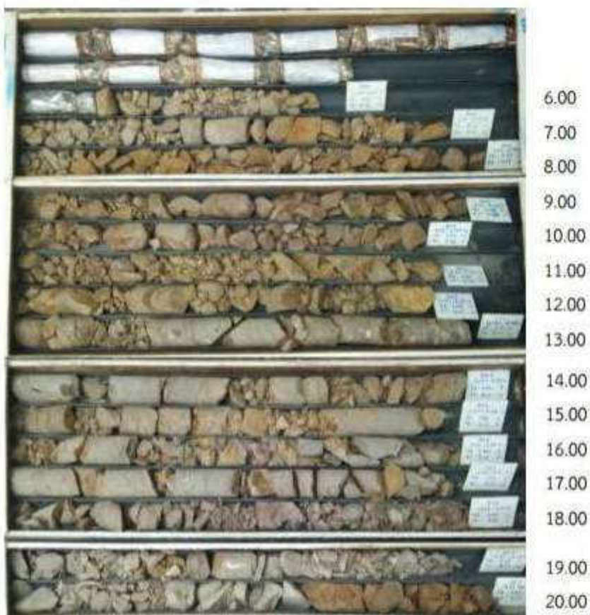
ค) ภาพถ่ายตัวอย่างดินและหินฐานรากแนวศูนย์กลางเขื่อนของหลุมเจาะสำรวจ DH.3
