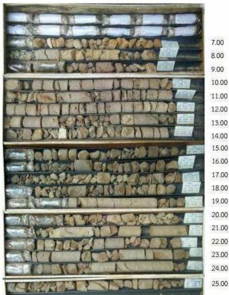
ข) ภาพถ่ายตัวอย่างดินและหินฐานรากแนวศูนย์กลางเขื่อนของหลุมเจาะสำรวจ DH.2
