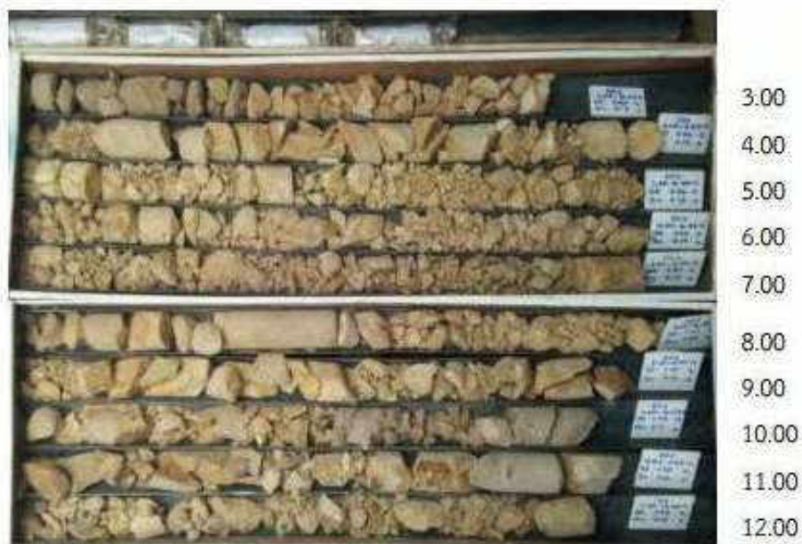
ง) ภาพถ่ายตัวอย่างดินและหินฐานรากแนวศูนย์กลางเขื่อนของหลุมเจาะสำรวจ DH.4
