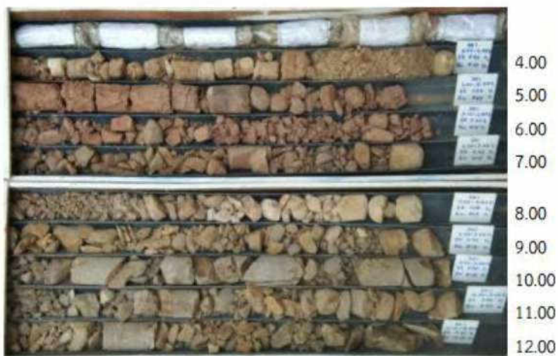
ก) ภาพถ่ายตัวอย่างดินและหินฐานรากแนวศูนย์กลางเขื่อนของหลุมเจาะสำรวจ DH.1
