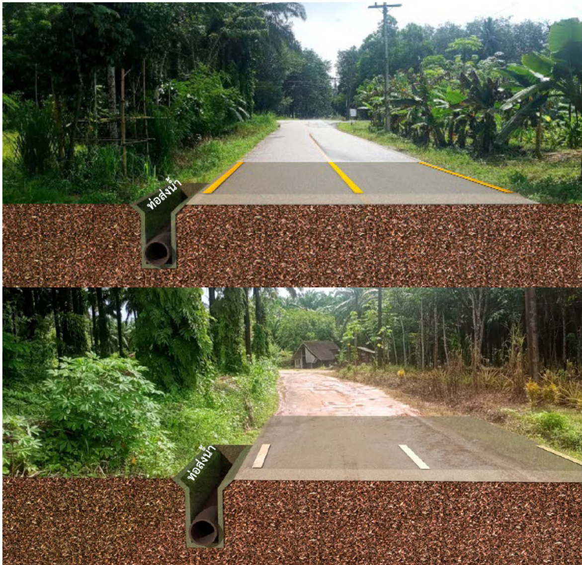
รูปที่ 2.3-10 ภาพจำลอง แนวท่อส่งน้ำ ระบบท่อส่งน้ำชลประทานของโครงการ
