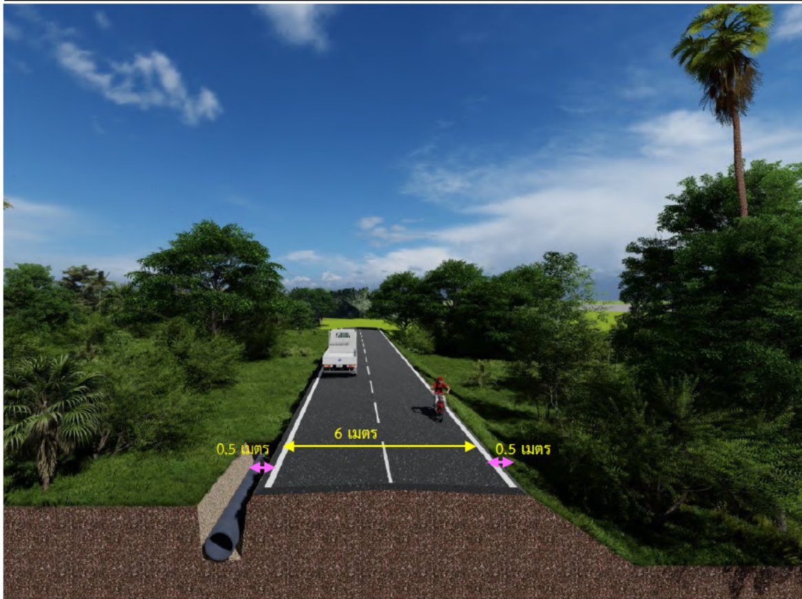
รูปที่ 2.3-13 รูปตัด และภาพจำลองถนนเข้าหัวงาน (กว้าง 6 เมตร ไหล่ทางข้างละ 0.5 เมตร)
