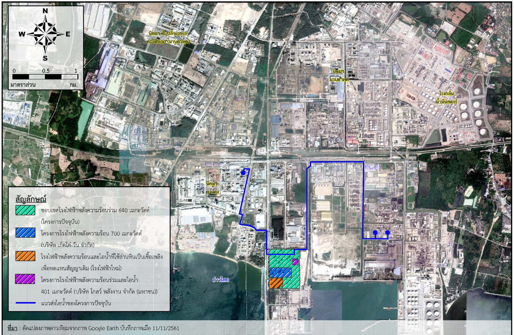
รูปที่ 2.6.1-3 แนวท่อส่งไอน้ำของโครงการปัจจุบันที่ส่งจำหน่ายให้กับโรงงานอุตสาหกรรมต่างๆ
