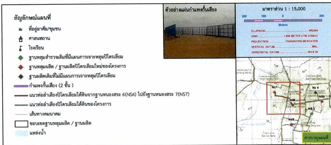
รูปที่ 2-13 ตำแหน่งติดตั้งกำแพงกั้นเสียงบริเวณแนวท่อลำเสียงปิโตรเลียมใต้ดินจากฐานหนองสระ 6 (NS6) ไปยังฐานหนองสระ 7 (NS7) ในระยะก่อสร้างและติดตั้ง
