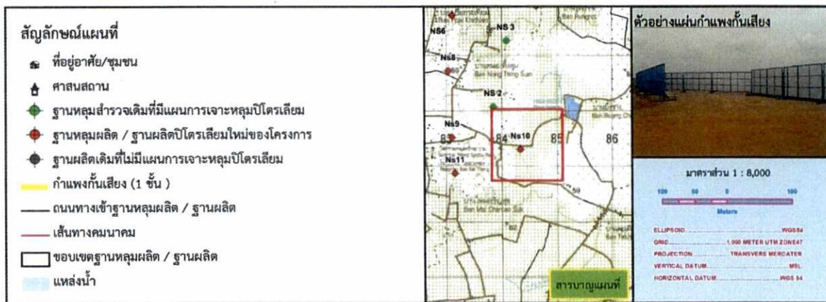
รูปที่ 2-6 ตำแหน่งติดตั้งกำแพงกันเสียง บริเวณฐานหนองสระ 10 (NS10) ในระยะก่อสร้างและติดตั้ง
