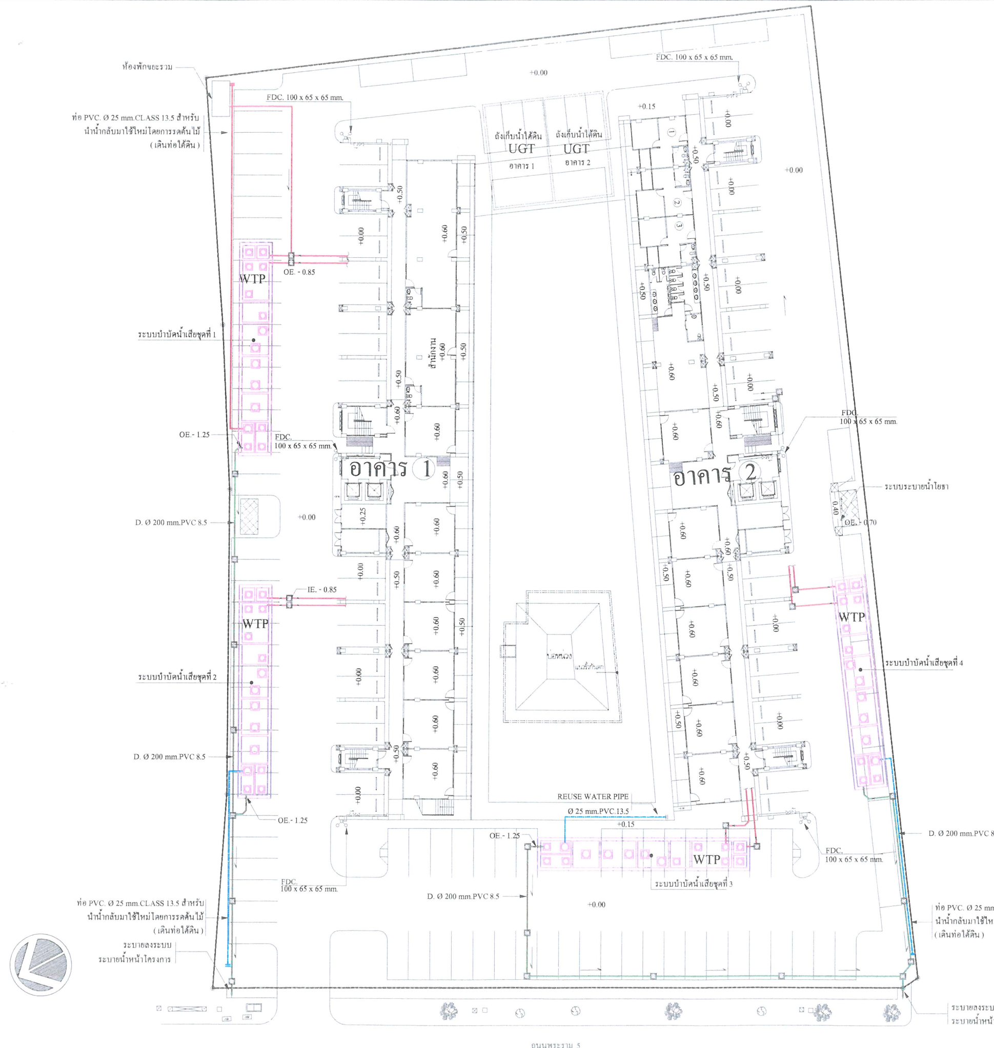
ภาพที่ 5 แผนผังระบบระบายน้ำเสียและแนวท่อน้ำทิ้งที่กลับมาใช้รดต้นไม้
