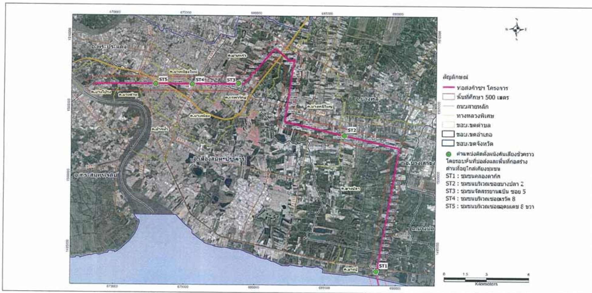
รูปที่ 3 ตำแหน่งติดตั้งหมักกันเสียงชั่วคราวโดยรอบพื้นที่บ่อส่งและพื้นที่ก่อสร้างด้านที่อยู่ใกล้เคียงชุมชน ในระยะก่อสร้างโครงการ
