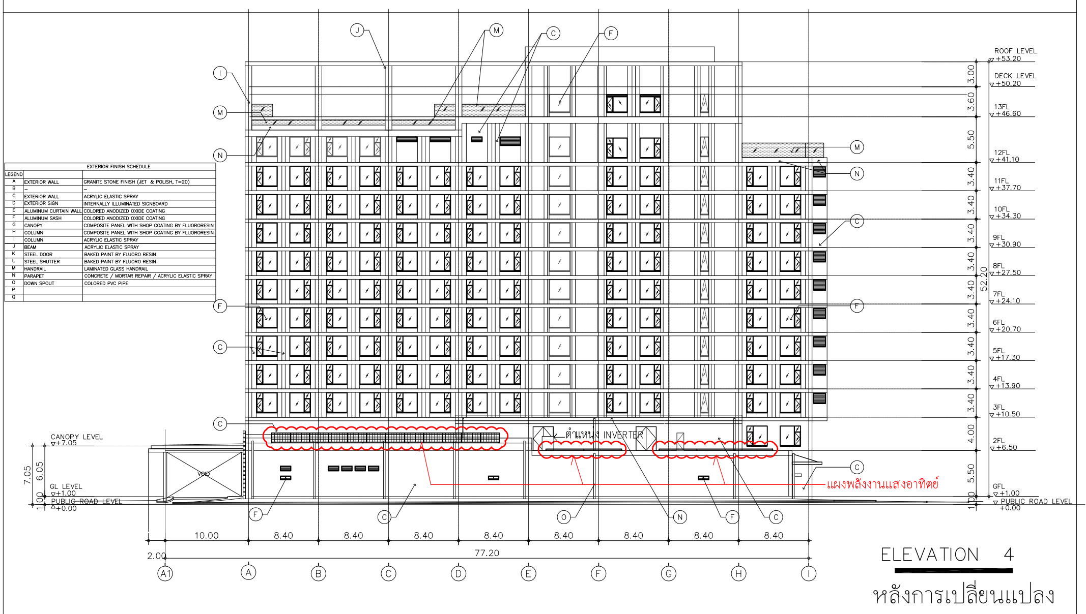
รูปที่ 2-4 : รูปด้าน 4 ของอาคารเดิม และหลังการเปลี่ยนแปลง
