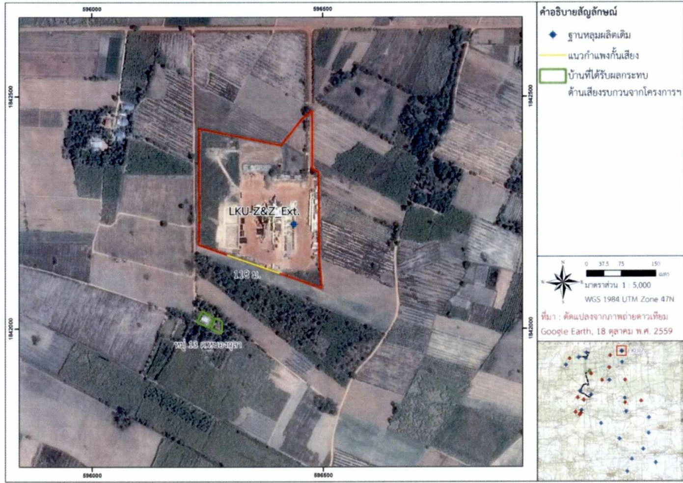
รูปที่ 16 แนวการติดตั้งกำแพงกันเสียงบริเวณขอบฐานหลุมผลิตลานกระบือ-แฮตแอนด์แฮต (ส่วนขยาย) (LKU-Z&Z_Ext.) ในระยะเจาะหลุมปิโตรเลียม
