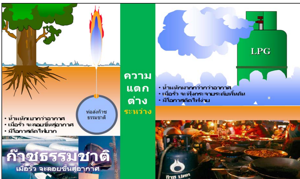
รูปที่ 1.4.2-1 ตัวอย่างความแตกต่างระหว่างก๊าซธรรมชาติและก๊าซหุงต้มเมื่อเกิดการรั่วไหลของก๊าซ
