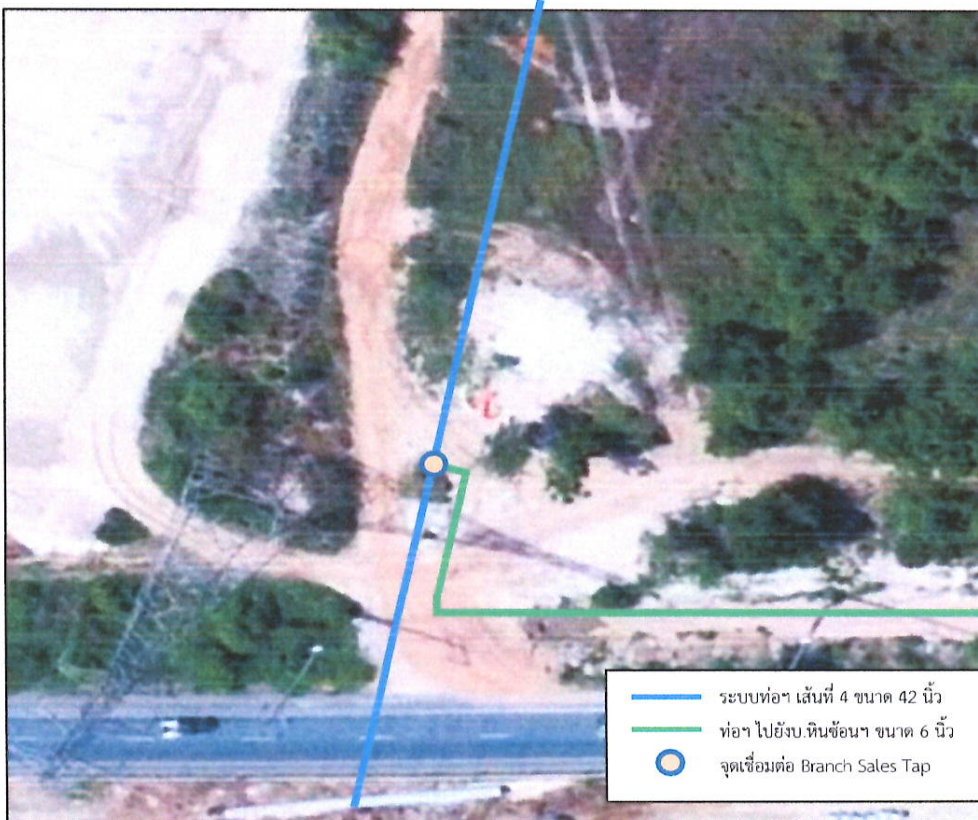
ก. แนวท่อส่งก๊าซฯ ที่ระบุในรายงานประเมินผลกระทบสิ่งแวดล้อมที่ได้รับความเห็นชอบ
