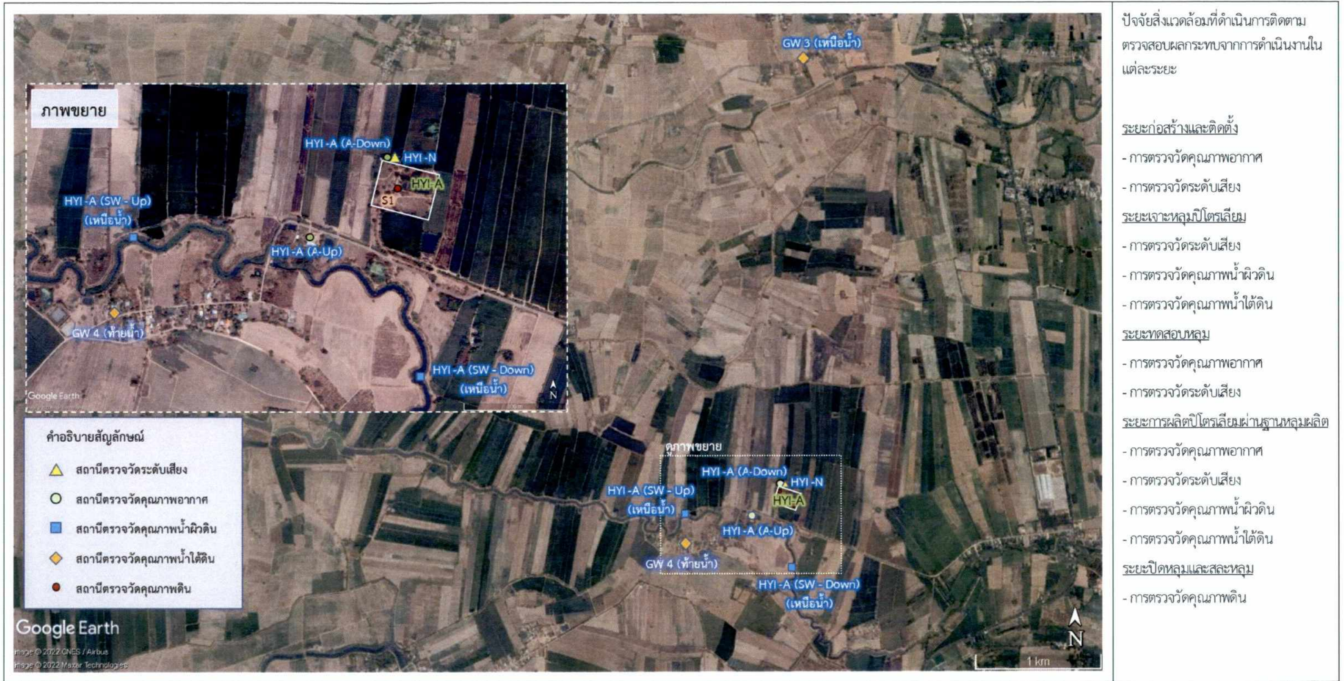
รูปที่ 8 ตำแหน่งติดตามตรวจสอบผลกระทบสิ่งแวดล้อม ทุกระยะดำเนินการสำหรับฐานหลุมผลิตห้วยใหญ่-เอ (HIYI-A) ที่ขอเปลี่ยนแปลงในรายงานการเปลี่ยนแปลงครั้งที่ 3
