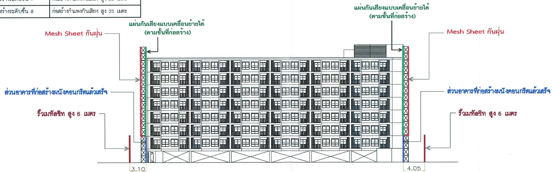
แบบขยายตัวอย่างการติดตั้งวัสดุกันเสียงที่ระดับชั้นเหนือพื้นขึ้นไป
