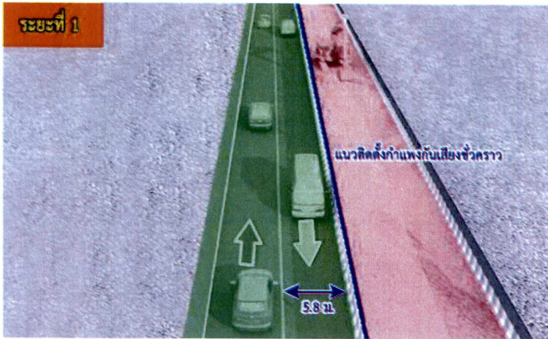
รูปที่ 5 แนวติดตั้งกำแพงกันเสียงชั่วคราวบริเวณชุมชนหมู่ 13 บ้านหัน ระยะที่ 1
