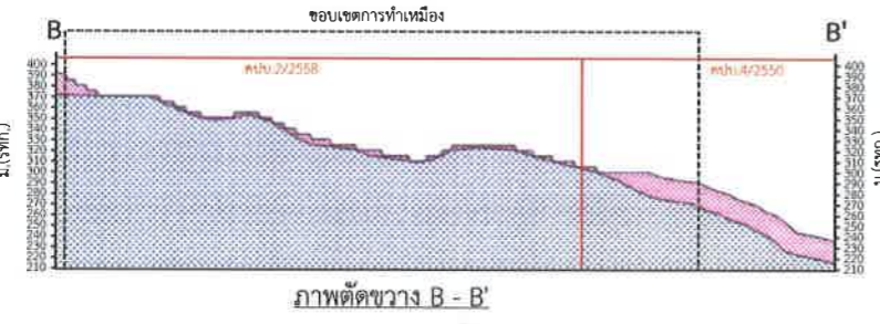
รูปที่ 10 แสดงลักษณะหน้าเหมืองและภาพตัดขวางเมื่อสิ้นสุดการทำเหมืองปีที่ 16-18
