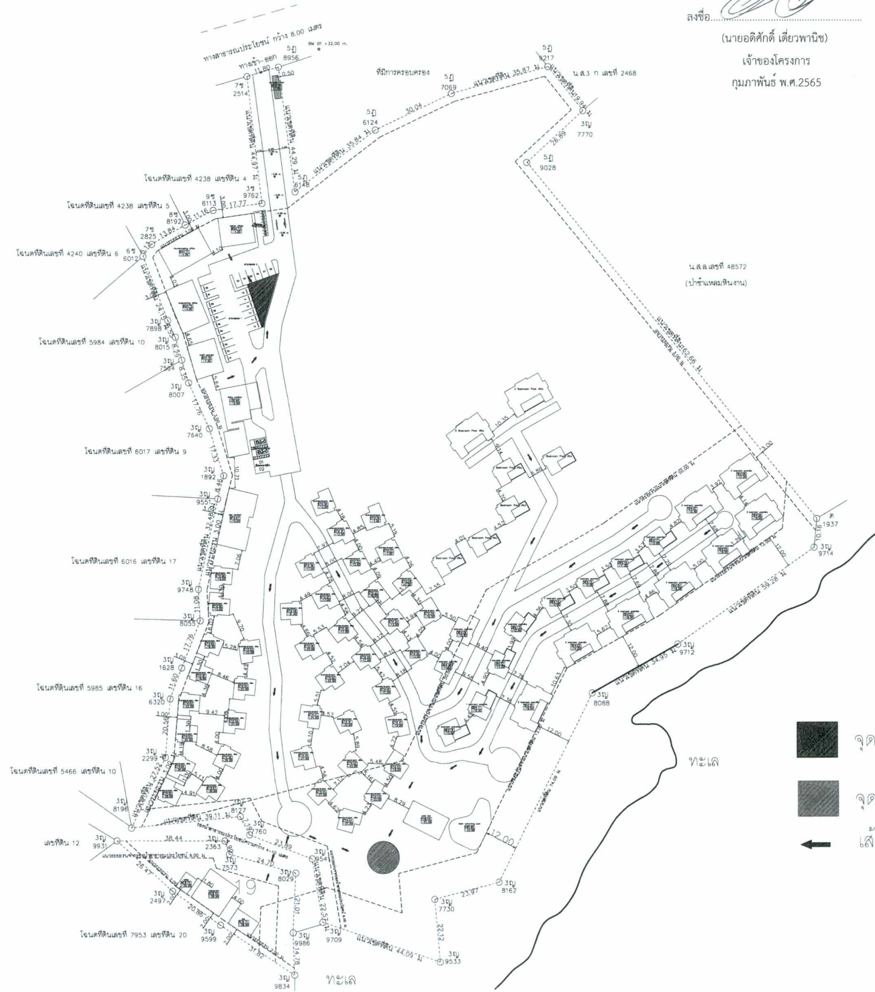
รูปที่ 11 ผังตำแหน่งจุดรวมพลและเส้นทางอพยพหนีไฟมายังจุดรวมพล
