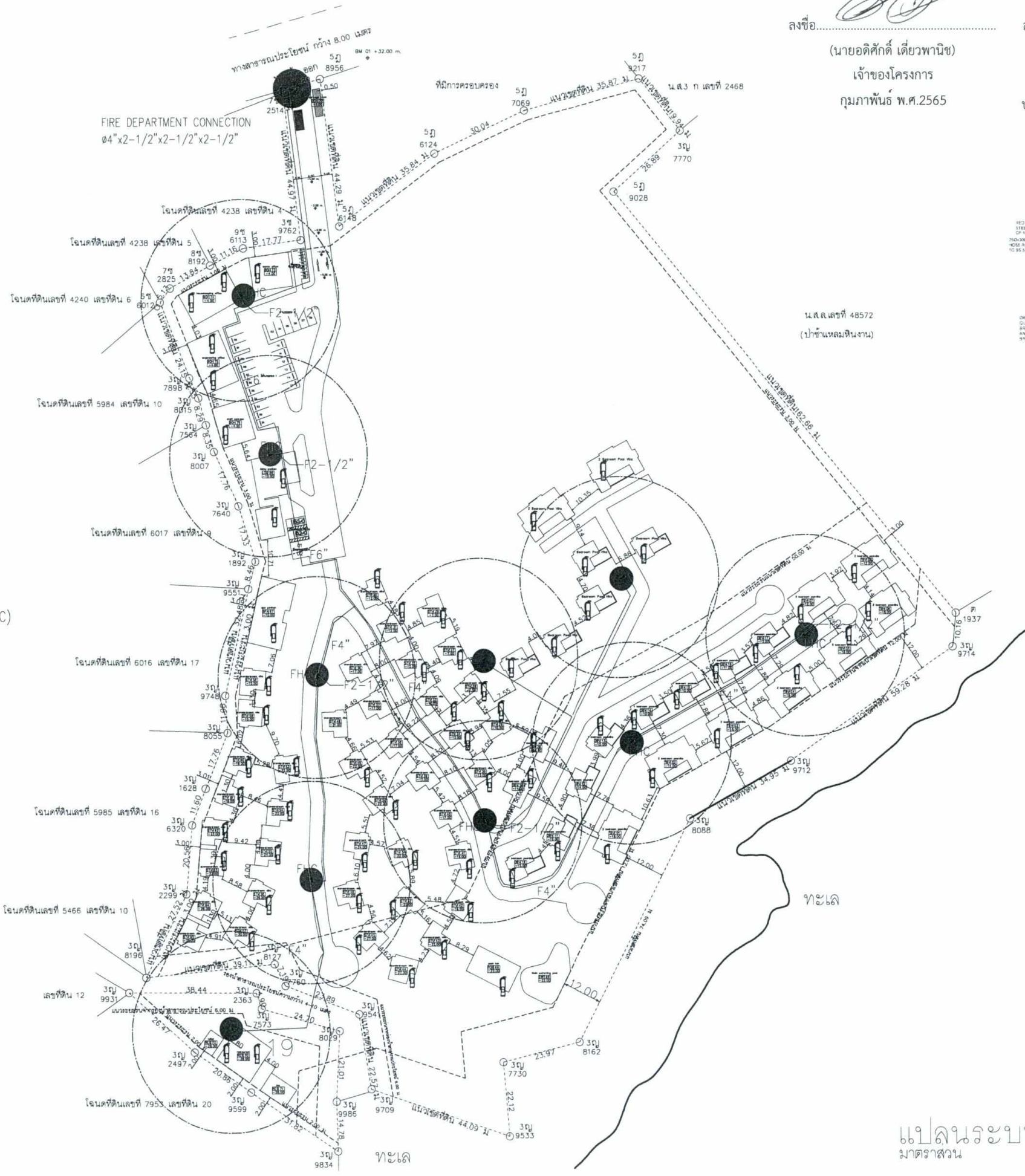
รูปที่ 10 ตำแหน่งถังดับเพลิงแบบมือถือ ตู้เก็บสายฉีดน้ำดับเพลิงพร้อมอุปกรณ์ หัวรับน้ำดับเพลิง และจุดจอตระดับเพลิง
