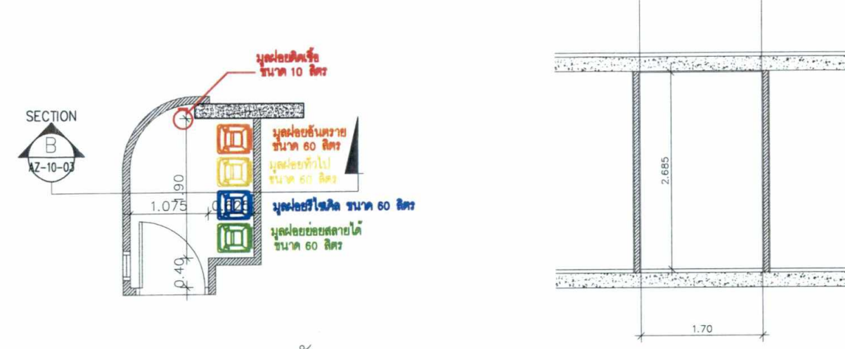
ผัง รูปตัด B แบบขยายห้องพักขยะประจำชั้น 1-4 อาคาร BEACHFRONT SOUTH, B มาตรฐาน 1:50@A1,1:100@A3
