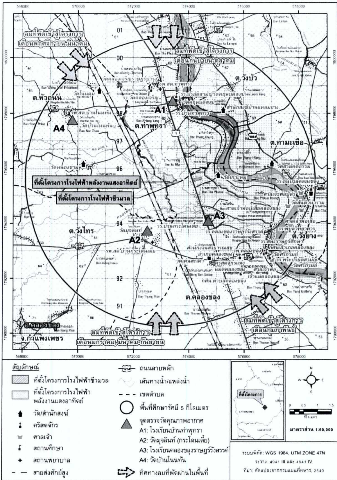
รูปที่ 1 สถานีตรวจวัดคุณภาพอากาศในบรรยากาศ ในระยะก่อสร้างและระยะดำเนินการ
