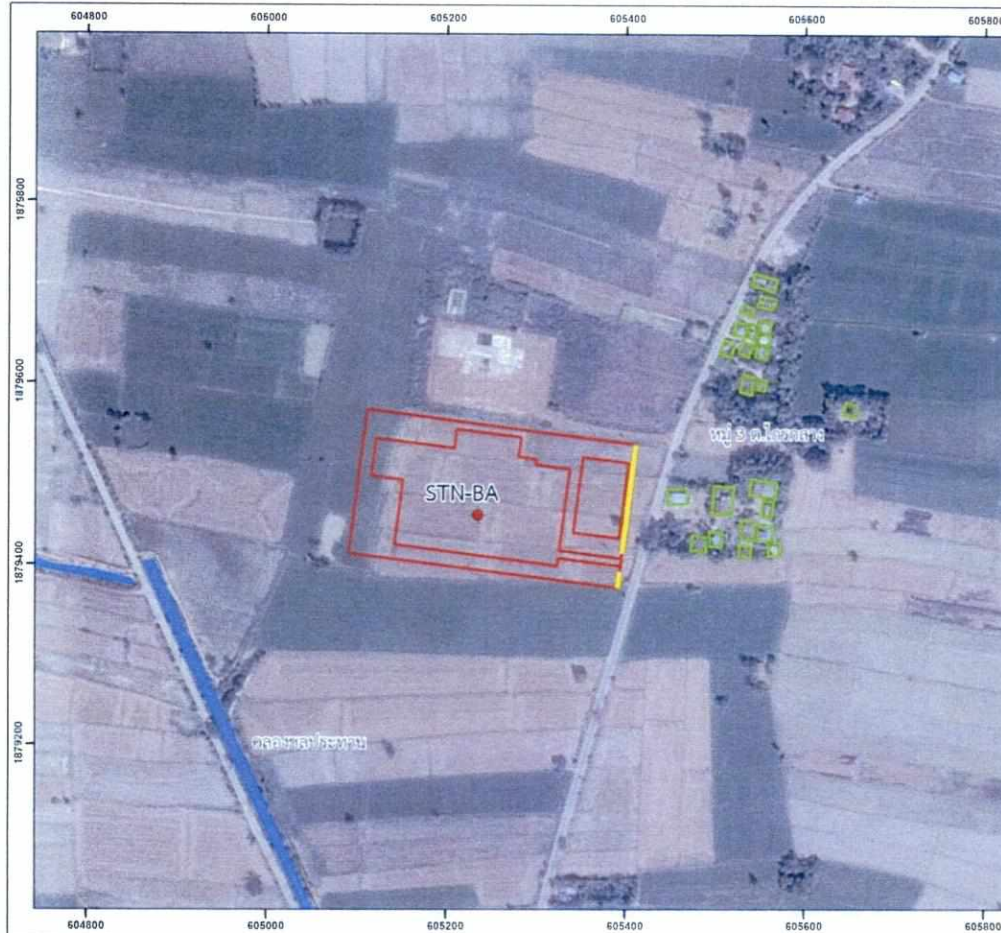
รูปที่ 3 แนวการติดตั้งกำแพงกันเสียงบริเวณขอบฐานหลุมผลิตเสาเถียร-บีเอ (STN-BA) ในระยะก่อสร้างและติดตั้ง
