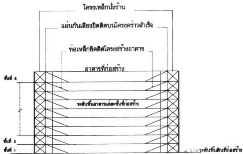
รูปแสดงการติดตั้งแผ่นกันเสียง
