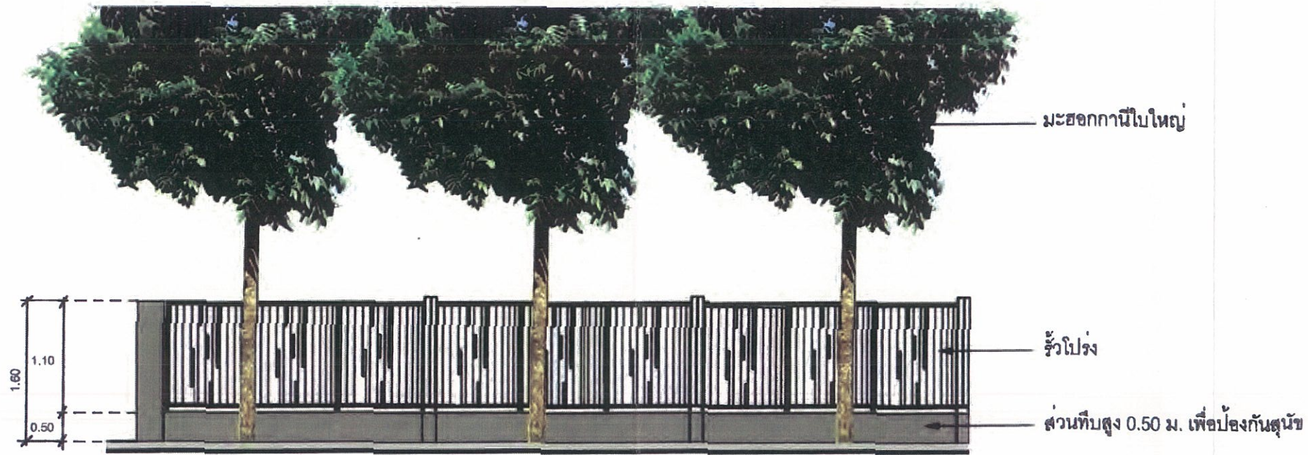
แบบแสดงรั้วโปร่งสูง 1.60 ม. (มุมมองจากในโครงการ)
