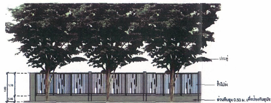
แบบแสดงรั้วโปร่งสูง 1.60 ม. (มุมมองจากในโครงการ)
