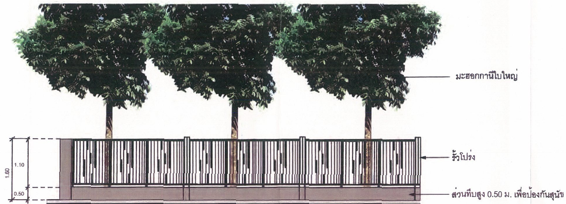
แบบแสดงรั้วโปร่งสูง 1.60 ม. (มุมมองจากในโครงการ)
