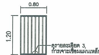
รายละเอียดแผ่นเกรงเหล็ก ① มาตราส่วน NTS.
