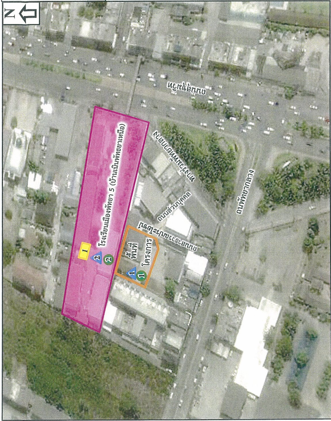
รูปที่ 12 : แผนผังแสดงจุดตรวจวัดคุณภาพอากาศ ระดับเสียง และความสั่นสะเทือน ในช่วงก่อสร้าง
