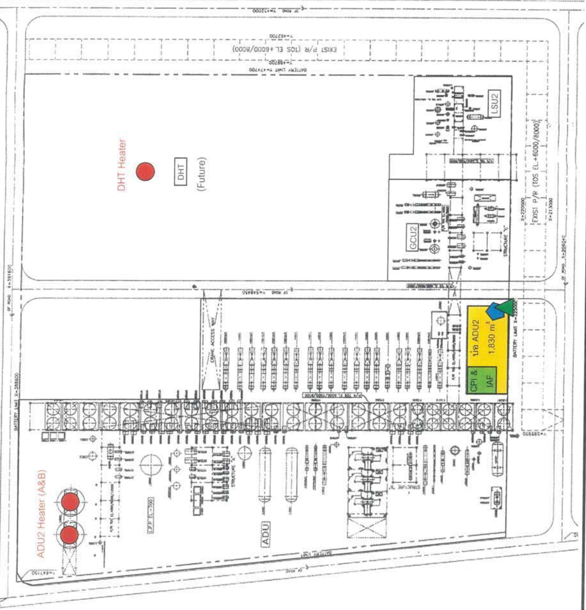
รูปที่ 6 จุดตรวจวัดคุณภาพอากาศจากปล่อง และคุณภาพน้ำในพื้นที่ส่วนการผลิต โครงการโรงกลั่นน้ำมัน ของบริษัท ไออาร์พีซี จำกัด (มหาชน)
