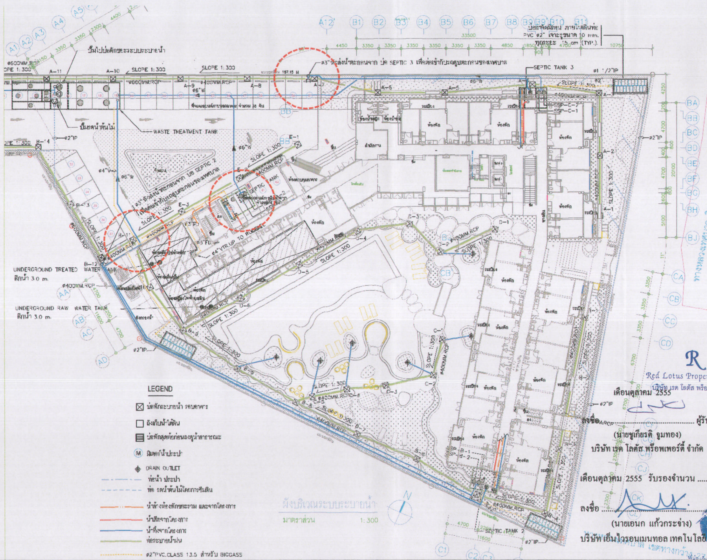
รูปที่ 7 แนวท่อร่น้ำคั้นไม้แบบซึมดินซึ่งฝังไว้บริเวณพื้นที่สีเขียวภายในโครงการ
