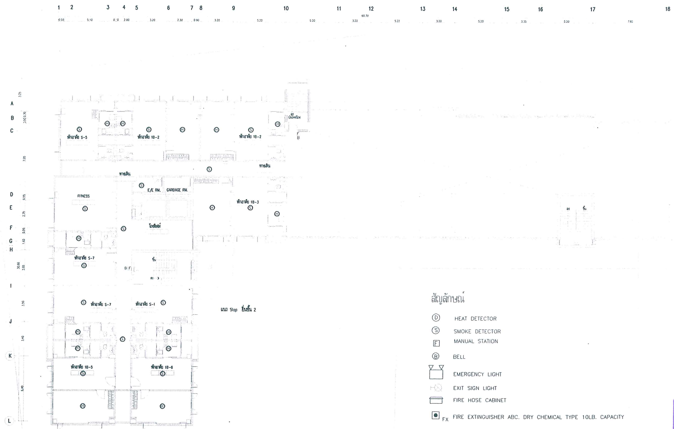
แปลนไฟฟ้า, ระบบสัญญาณเตือนอัคคีภัย และดับเพลิง ชั้นที่ 2 1 : 200
