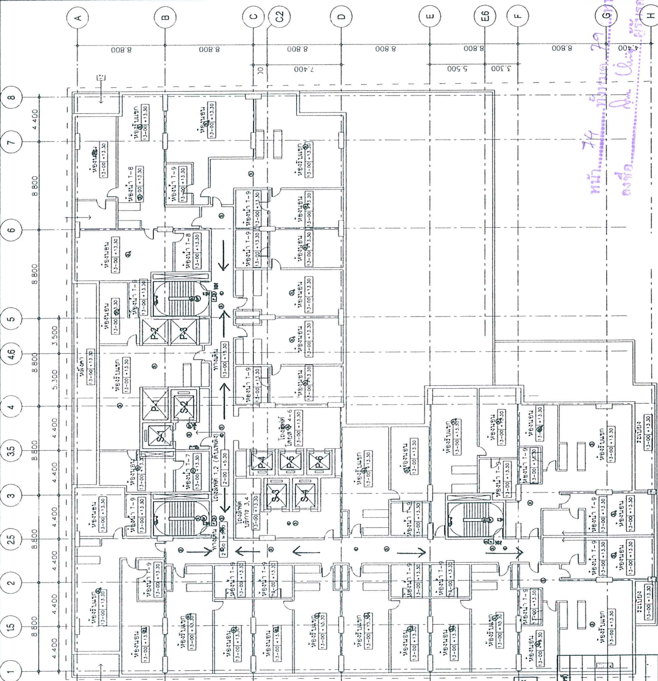
รูปที่ 38 : แผนระบบป้องกันอัคคีภัยและเส้นทางหนีไฟชั้น 21-22
