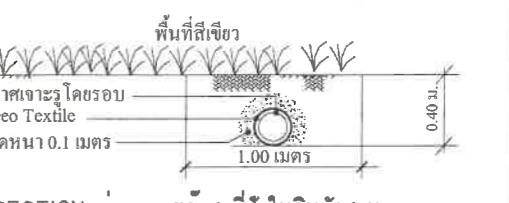
SECTION ท่อระบายก๊าซ ที่ฝังในดินจัดสวน NTS ระบบกำจัดละอองน้ำเสียจากเครื่องเดิมอากาศ แบบ Soil Bed.
