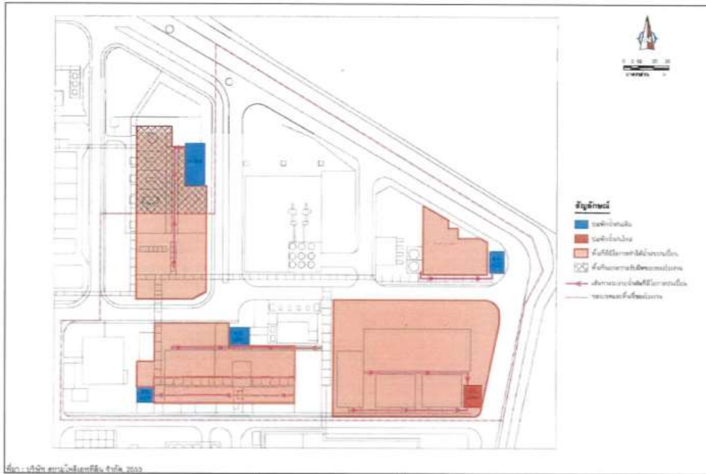
รูปที่ 1.4-4 แผนผังระบบจ่ายน้ำภายในโครงการ
