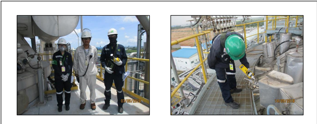
รูปที่ 1 ตัวอย่างอุปกรณ์และการตรวจวัดการรั่วซึมจากอุปกรณ์ในโรงงานที่เป็นแหล่งกำเนิดชนิดฟุ้งกระจาย
